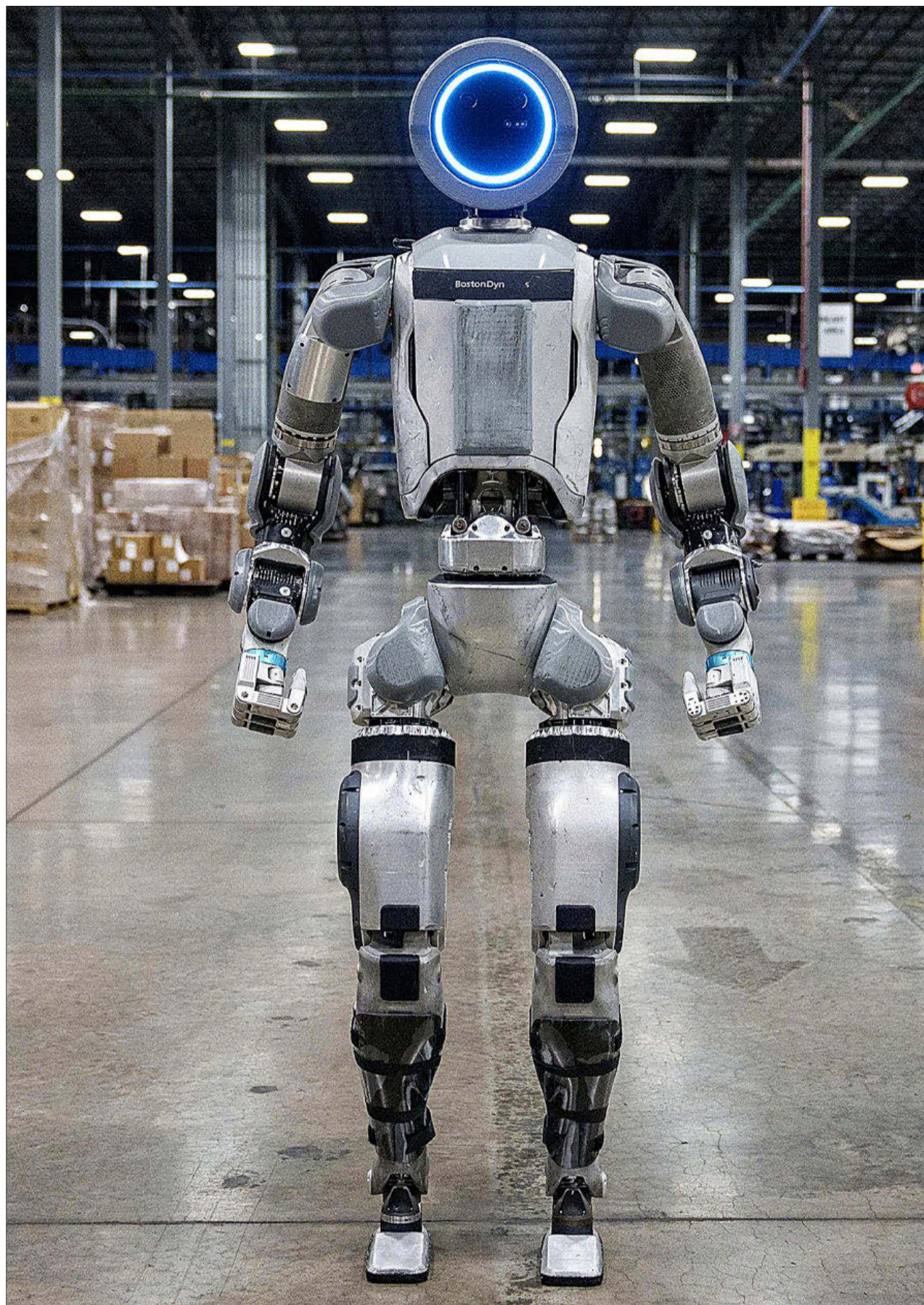
El humanoide Atlas de Hyundai es capaz de coger piezas de 50 kilos a una altura de 2,3 metros. HYUNDAI
